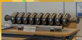
電子など素粒子の通り道となる、ILCの中で最も重要な部品「超伝導加速9セル空洞」を展示します！
